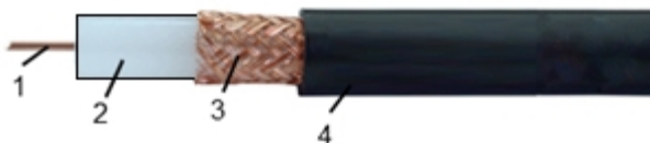
Рисунок 2.1 – Конструкция коаксиального кабеля РК75-9-12: 1 – центральная жила; 2 – изолирующий диэлектрик; 3 – экран; 4 – оболочка
