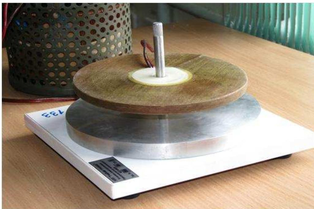
**Рис. 11.** Левитация катушки над массивным диском
