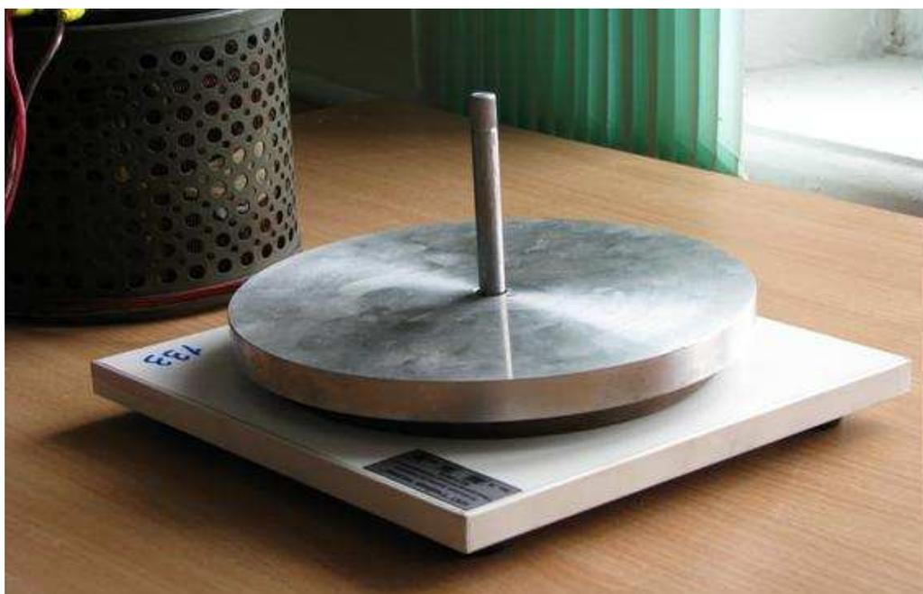
**Рис. 8.** Массивный диск на катушке в исходном состоянии
