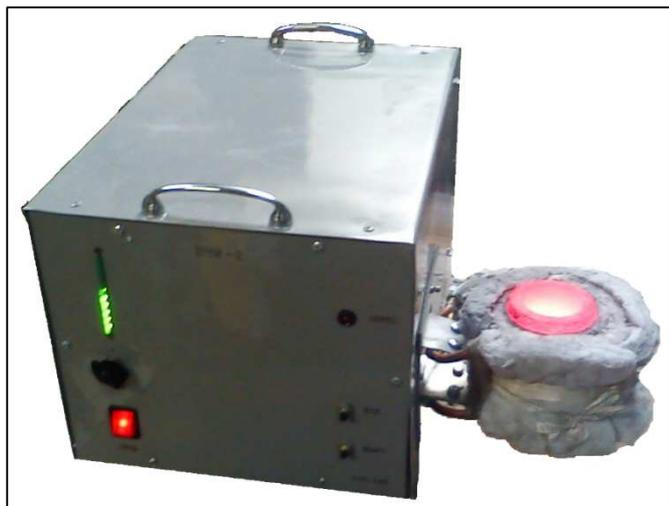
**Рис. 6.** Экспериментальная установка с ИТП для плавки драгоценных металлов
