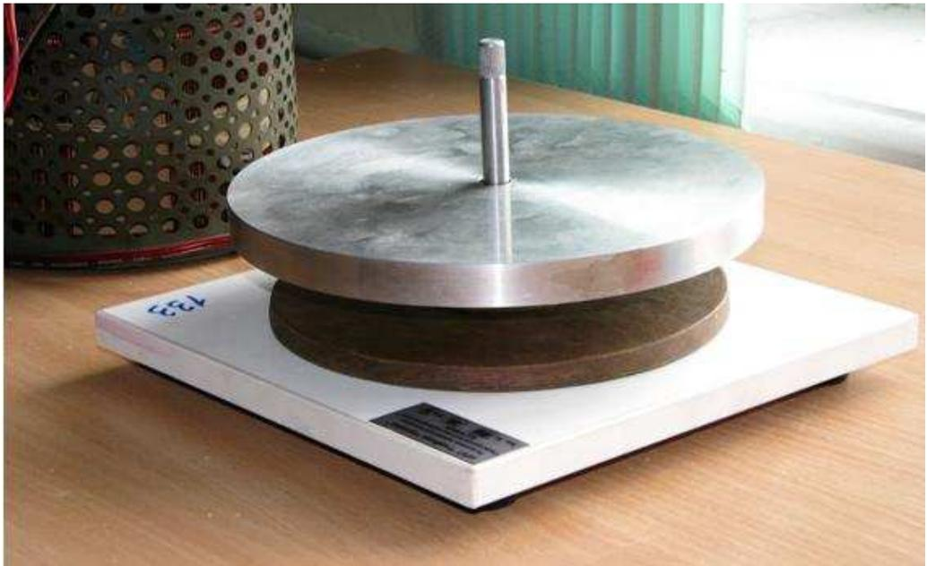
**Рис. 9.** Левитация массивного диска
