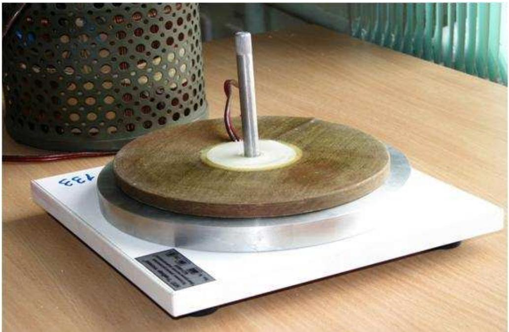
**Рис. 10.** Катушка размещена над массивным диском (исходное положение)
