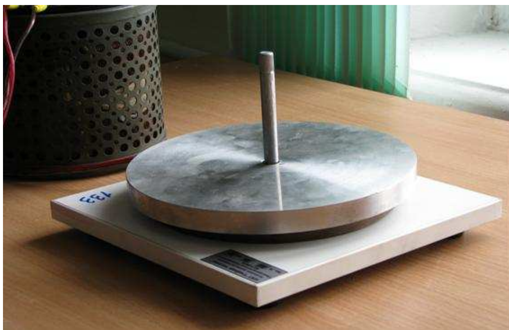
Рис. 8. Массивный диск на катушке в исходном состоянии
