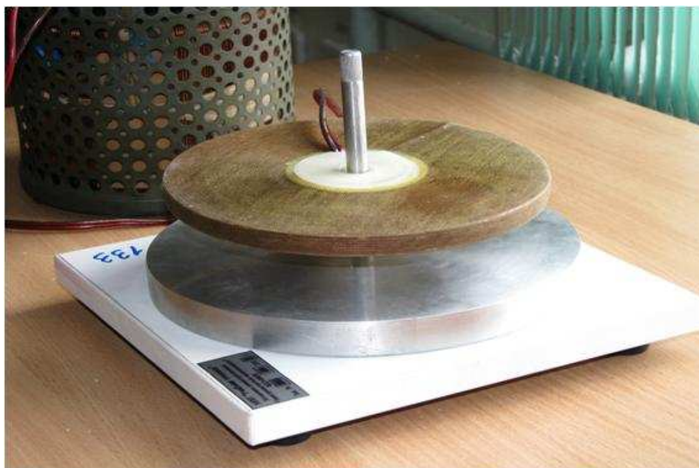
Рис. 11. Левитация катушки над массивным диском
