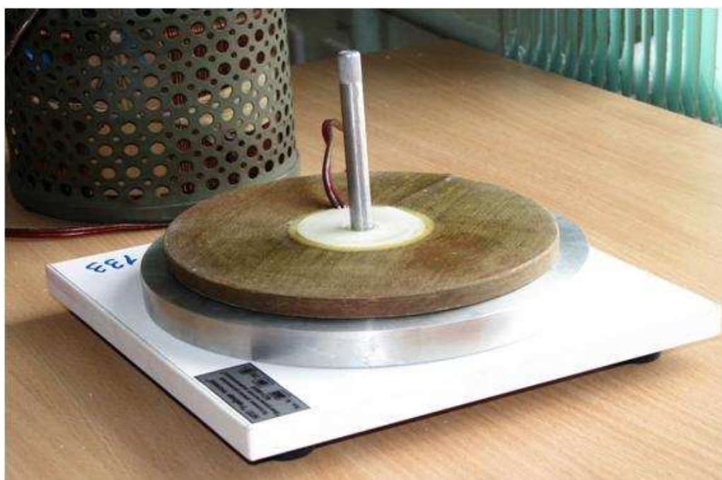
Рис. 10. Катушка размещена над массивным диском (исходное положение)
