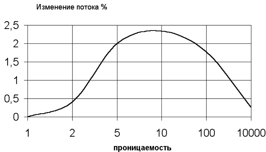
Рис. 5. Зависимость относительного изменения магнитного потока через торец магнита при появлении в стальной плите щели шириной 1 и глубиной 19 миллиметров от магнитной проницаемости материала плиты. По горизонтали - относительная проницаемость материала плиты. По вертикали - относительное изменение потока в процентах.
