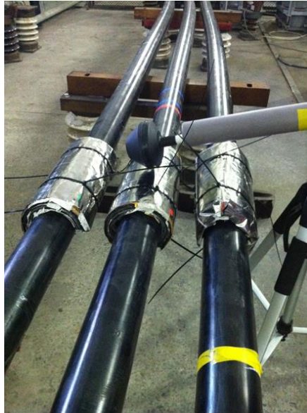
Рис. 5.34. Измерение характеристик магнитного поля вблизи экранированной КЛ проложенной в горизонтальной плоскости с просветом в диаметр кабеля.
