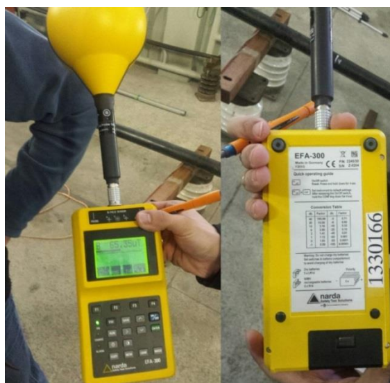
Рис.5.30. Процесс измерений индукции магнитного поля с помощью прибора Narda EFA-300
