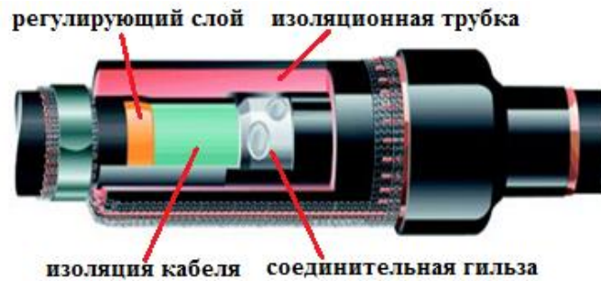
Рис.1.8 Резистивное управление полем в соединительной муфте.
