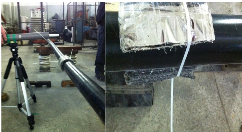
Рис.5.29. Магнитный экран, надвинутый поверх кабеля
