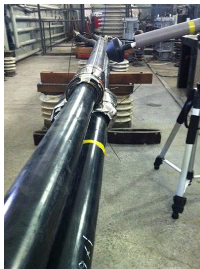
Рис.5.33. Измерение характеристик магнитного поля вблизи экранированной КЛ проложенной треугольником встык.
