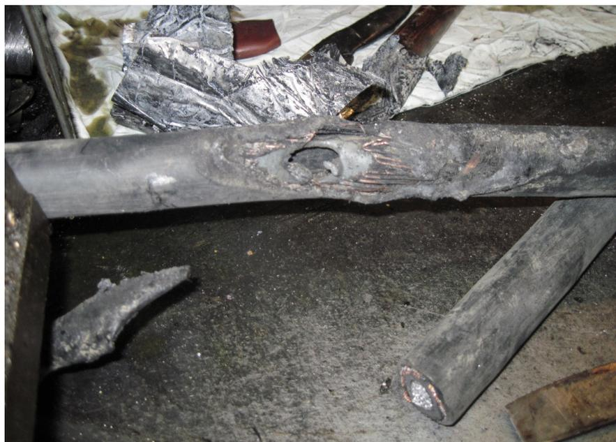
**Рис. 1.** Характер повреждений кабеля АПвПуг-1х120/35-10 в результате ОЗ с током 340 А, перешедшего, через 2 с в двухфазное короткое замыкание
