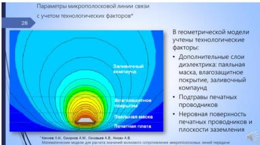
Последняя из рассмотренных задач – анализ параметров микрополосковой линии связи на печатной плате с учетом технологических факторов: паяльной маски, покрытия, компаунда и технологических искажений формы.
