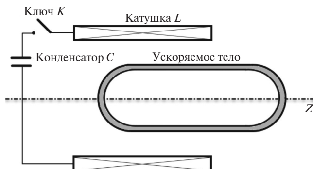
Рис. 1. Геометрия и электрическая схема задачи
