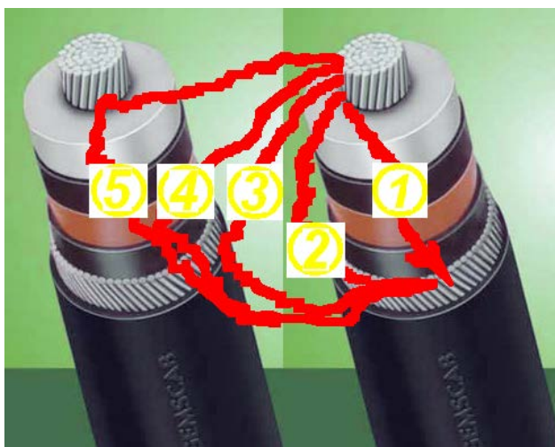
Рис. 8. Стадии процесса перехода однофазного замыкания на землю в сети с изолированной (компенсированной) нейтралью в междуфазное КЗ:
