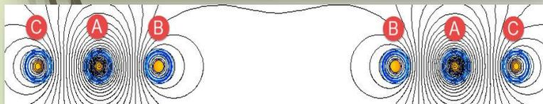
Магнитное поле пары кабельных линий без магнитного экрана
