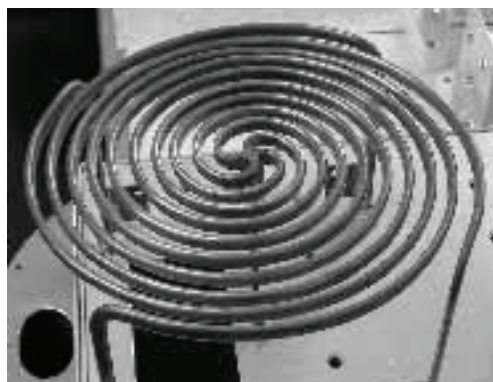
Рис. 3. Спираль реального источника индуктивно-связанной плазмы
