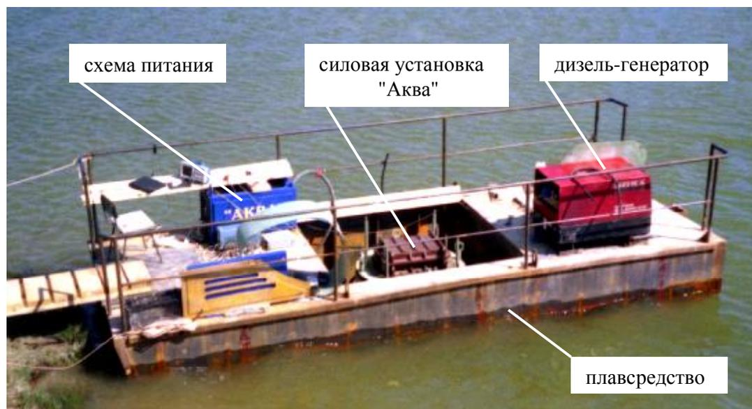
а) испытания на воде
