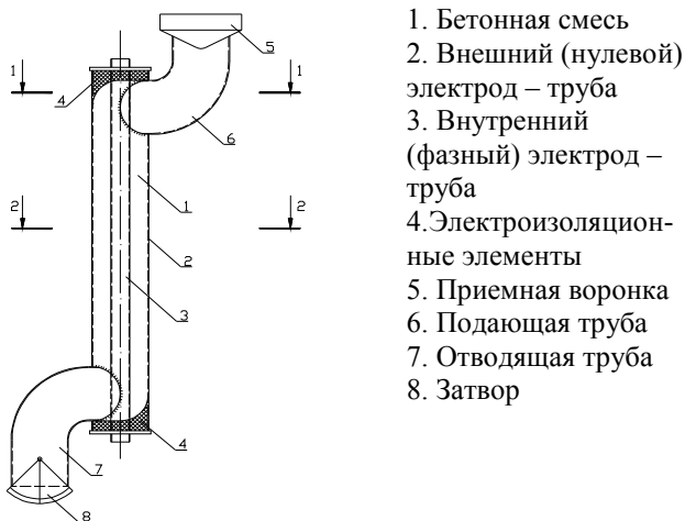
Рис. 1. Схема исследуемого ЭРУ непрерывного действия
