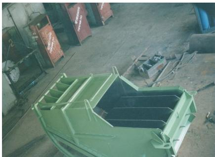
Рисунок 16. Общий вид поворотного бункера по патенту RU 2193484
