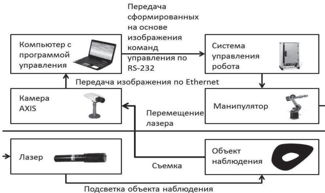
Рис. 1. Структура системы управления сборочным манипулятором
