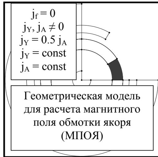
5. Неявнополюсная синхронная машина нормального типа с немагнитным ротором и статором (Вар.5.НСМ-НТ-НРС)
