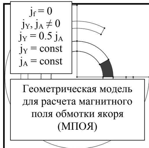
1. Магнитные поля неявнополюсной синхронной машины нормального типа с беспазовым ферромагнитным ротором и статором
