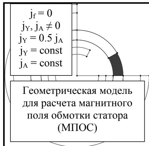
4. Неявнополюсная синхронная машина обращенного типа с немагнитным индуктором и беспазовым ферромагнитным якорем (Вар.4.НСМ-ОТ-НИ-БФЯ)
