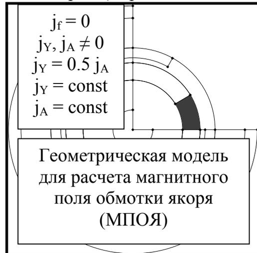
3. Неявнополюсная синхронная машина нормального типа с немагнитным ротором и беспазовым ферромагнитным статором (Вар.3.НСМ-НТ-НР-БФС)
