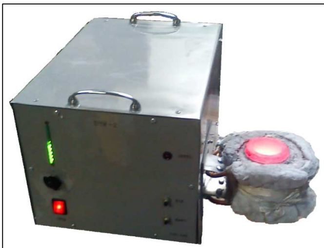
Рис. 6. Экспериментальная установка с ИТП для плавки драгоценных металлов
