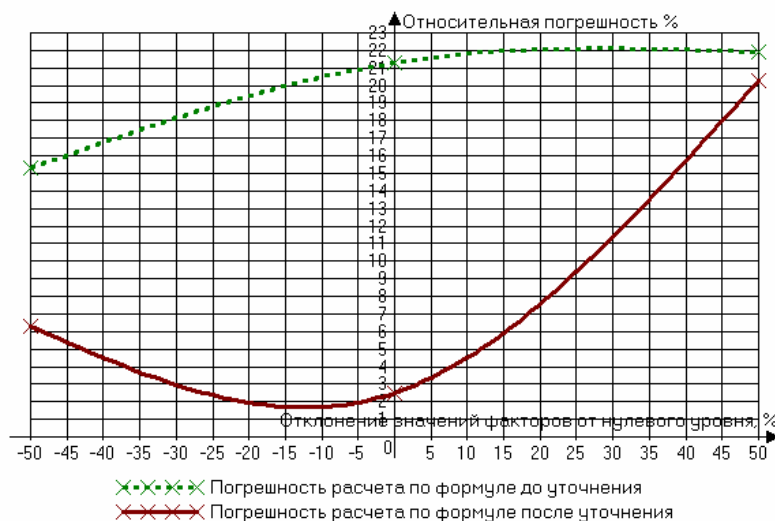
Рис. 9. Зависимость относительной погрешности расчета дифференциального полного сопротивления микрополосковой пары по не уточненной (пунктирная линия) и уточненной (сплошная линия) формулам от отклонения значений факторов от нулевого уровня
