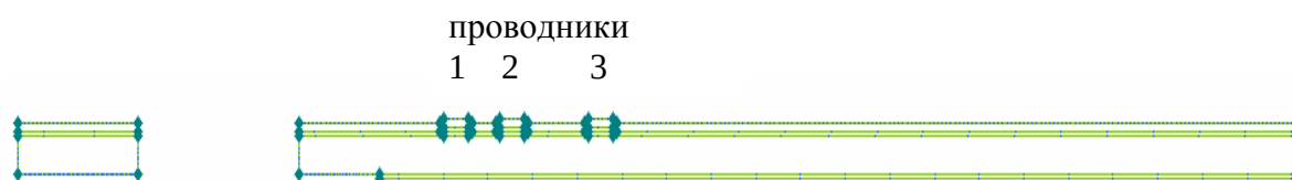
Рис. 8. Сечение исследуемой микрополосковой дифференциальной пары: 1, 2 – дифференциальная пара, 3 – одиночный проводник (микрополосковая пара II)
