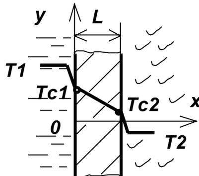
Рис. 5.3. Процесс передачи теплоты через плоскую стенку теплопроводностью в задаче **Stenka1**
