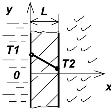
Рис. 5.2. Процесс передачи теплоты через плоскую стенку теплопроводностью в задаче **Stenka**
