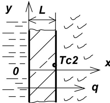
Рис. 5.4. Процесс передачи теплоты через плоскую стенку теплопроводностью в задаче **Stenka2**
