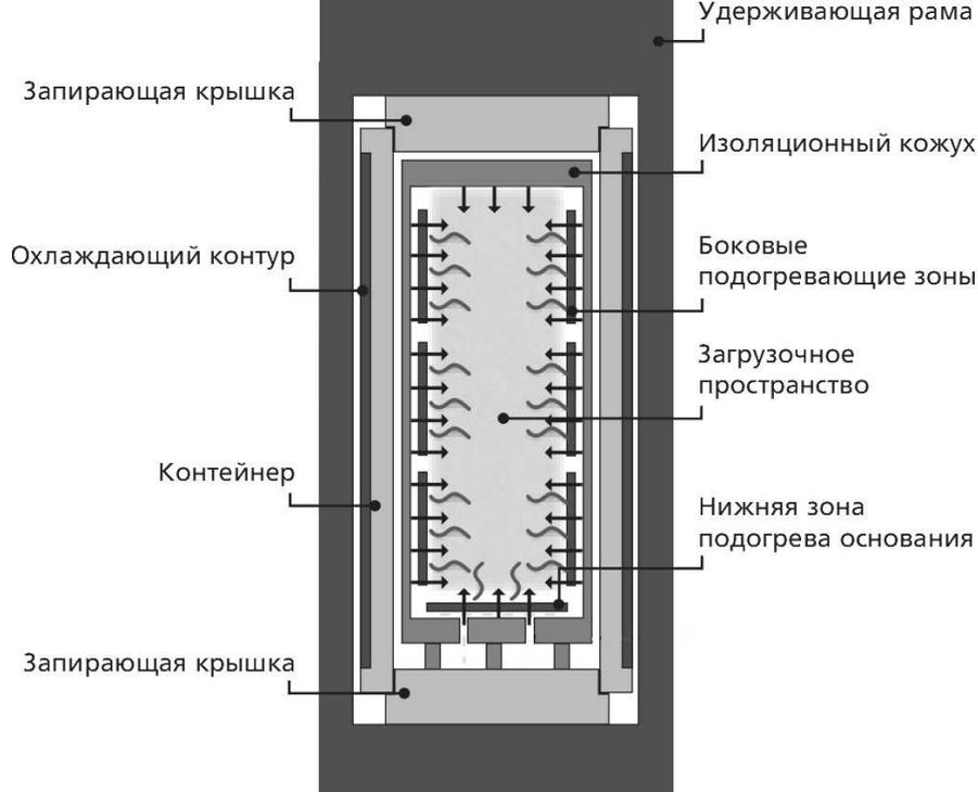
прорезями, так как именно этот материал наименее требователен к рабочей среде, в частности, к газам, выделяющимся во время процесса. Нижний плоский нагреватель изготавливается из того же материала, что и боковой. Типичная конструкция газостатов высокого давления с резистивной нагревательной системой показана на рис. 1. Подвод электроэнергии к боковому нагревателю осуществляется через верхнюю запирающую крышку, а к донному нагревателю - через нижнюю крышку.
