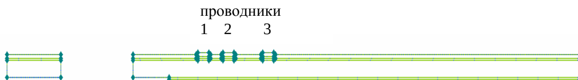
Рис. 1. Сечение исследуемой микрополосковой дифференциальной пары: 1, 2 – дифференциальная пара, 3 – одиночный проводник
