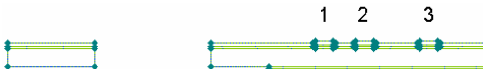
Рис. 2. Сечение исследуемой микрополосковой дифференциальной пары: 1, 2 – дифференциальная пара, 3 – одиночный проводник
