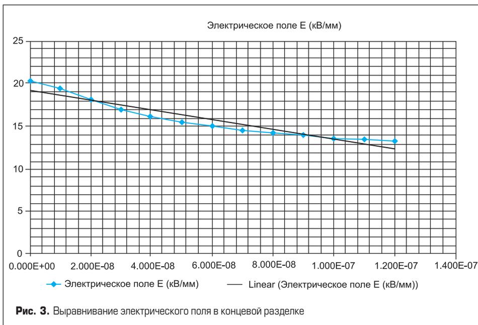
Рис. 3. Выравнивание электрического поля в концевой разделке
