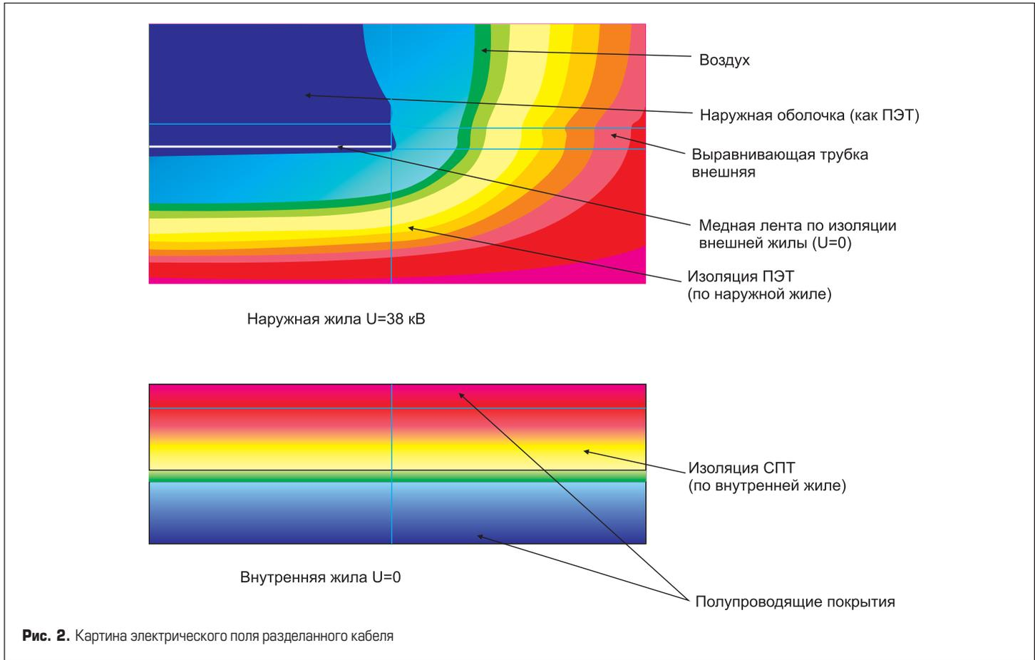
Рис. 2. Картина электрического поля разделанного кабеля
