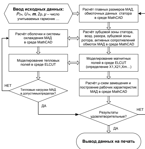
Рис.2 Структурная схема программно-вычислительного комплекса проектирования и расчёта m -фазного асинхронного двигателя
