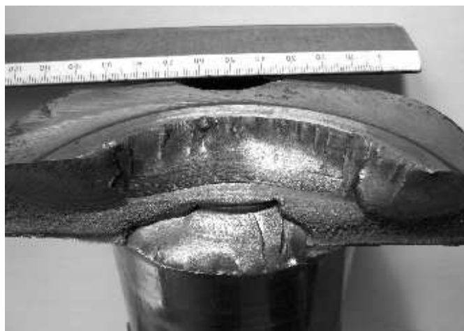
Рис. 1. Форма усталостного разрушения коленчатого вала по щеке
