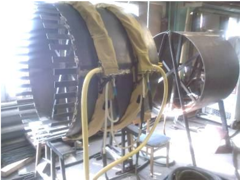
Рис.8. Фото мягкого гибкого индуктора на трубе
