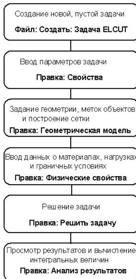
Рис. 1. Типичная последовательность шагов при решении новой задачи в ELCUT
